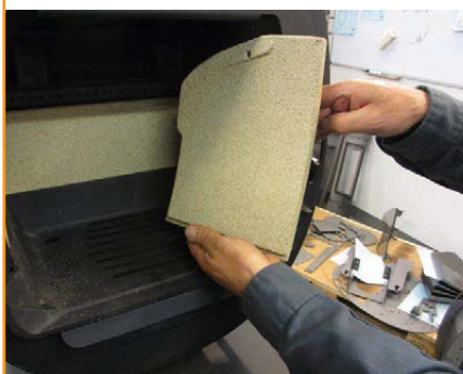
Zamontować boczną prawą płytę zaczynając od góry
